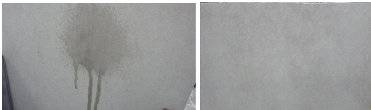
図.1 霧吹き後の写真(左：塗装が不十分、右：塗装十分)
