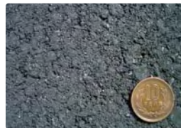
密粒アスファルト (一般的な舗装)
