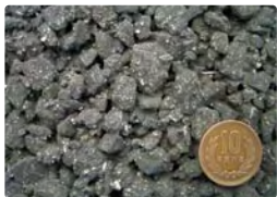
開粒アスファルト (透水機能を持った舗装) 骨材の粒度が大きく、空隙を有し、表面の質感が通常のアスファルトより軟らかい。
